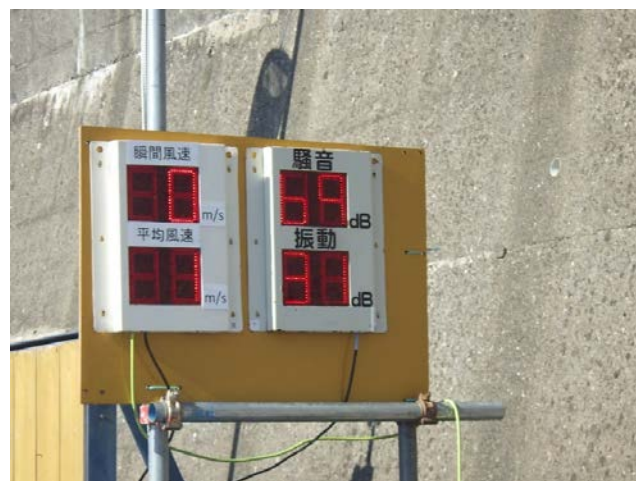
鋼管杭を圧入するため騒音・振動を常に観測し、周辺環境に配慮をする。
