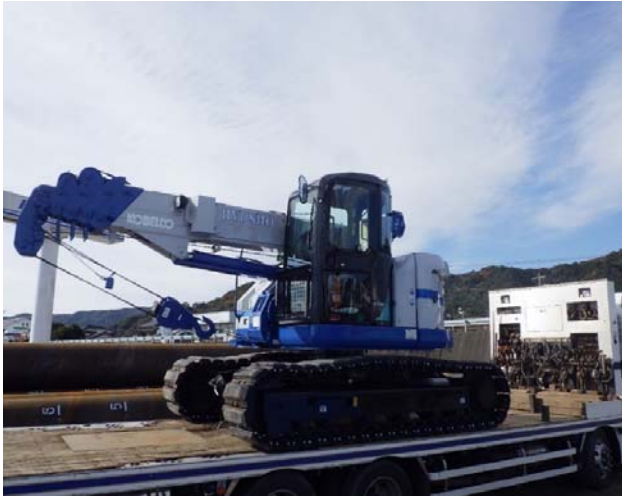
クローラークレーン4.9t吊（コベルコ製）超低騒音型・排出ガス2014年基準適合車）
