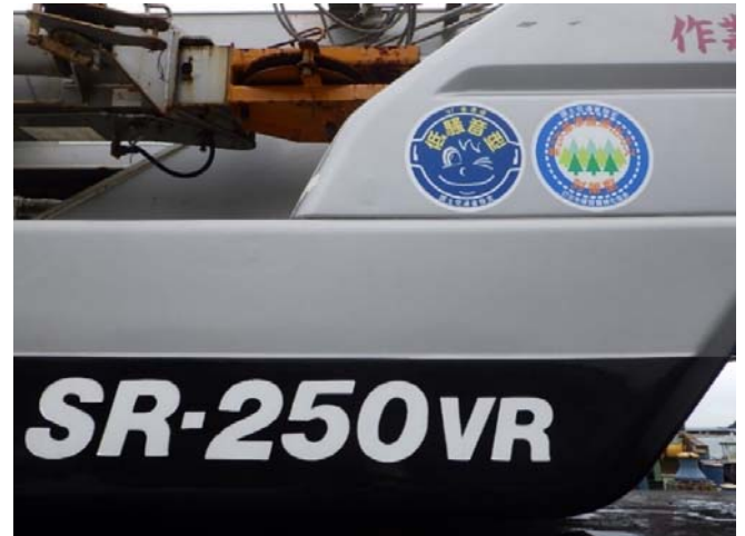
ラフテレーンクレーン26t吊（カトウ製）低騒音型・第2次基準値排出ガス対策型
