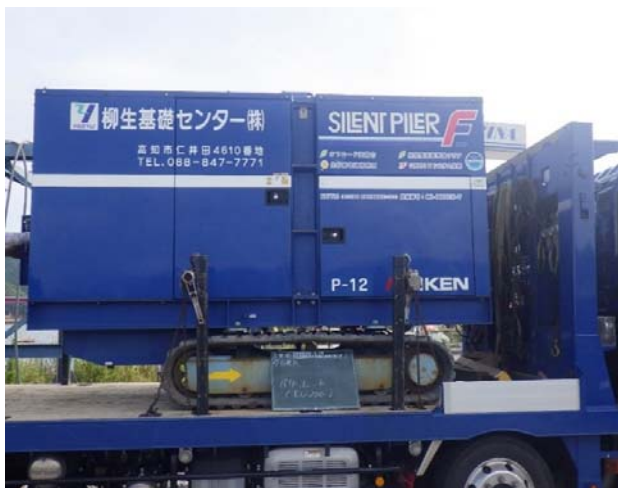
サイレントパイラー用パワーユニット（オフロード法適合・超低騒音・生分解性油脂採用・NETIS登録）
