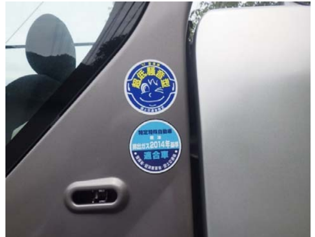
バケット容量0.25m³バックホウ（コベルコ製）超低騒音型・排出ガス2014年基準適合車
