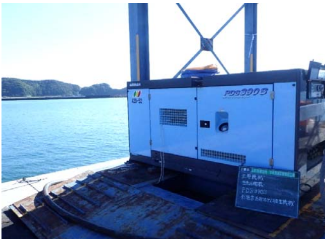
コンプレッサー空気量11m 3 /min（北越工業製）低騒音型・第3次基準値排出ガス対策型
