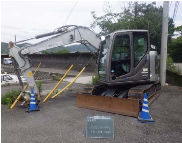
バケット容量0.25m³バックホウ（コベルコ製）超低騒音型・排出ガス2014年基準適合車
