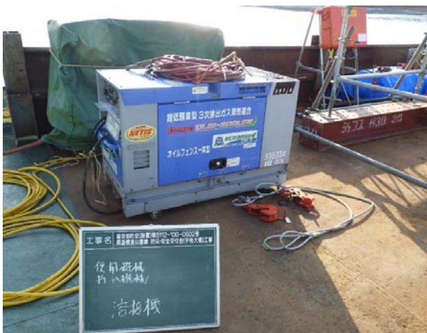
溶接機超低騒音型・第3次基準排出ガス対策型
