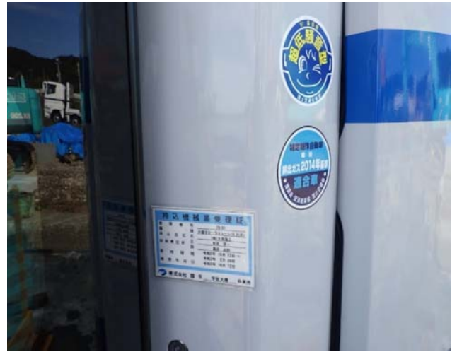
クローラークレーン4.9t吊（コベルコ製）超低騒音型・排出ガス2014年基準適合車）
