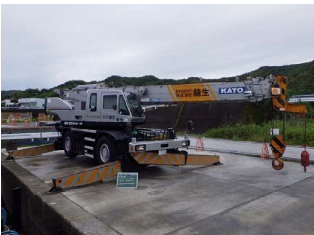
ラフテレーンクレーン26t吊（カトウ製）低騒音型・第2次基準値排出ガス対策型
