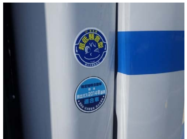
クローラークレーン4.9t吊（コベルコ製）超低騒音型・排出ガス2014年基準適合車
