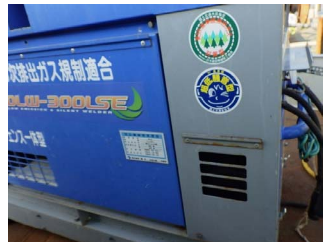
溶接機超低騒音型・第3次基準排出ガス対策型
