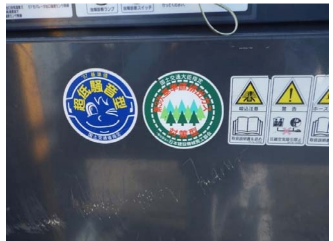
コンプレッサー空気量11m 3 /min（北越工業製）低騒音型・第3次基準値排出ガス対策型
