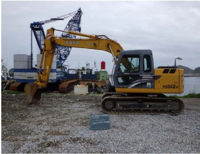
バケット容量0.45m 3 バックホウ（カトウ社製）低騒音型・排出ガス基準適合車
