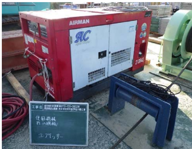
コンプレッサー超低騒音型・第3次基準排出ガス対策型）
